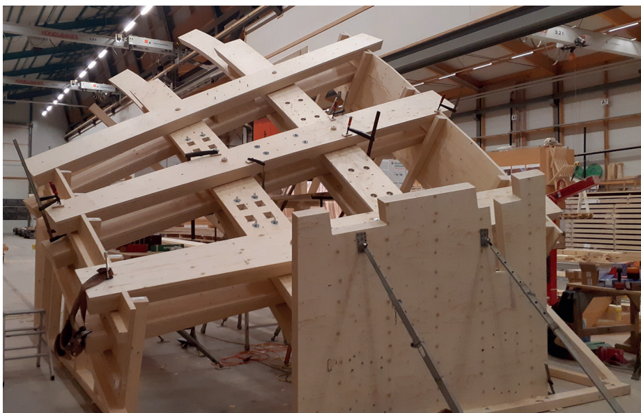
Figur 4: Mock-ups är ovärderliga i sådana här komplexa konstruktioner.
