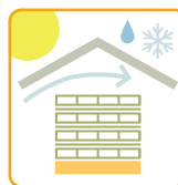
Impregnerat virke ska skyddas med topptäckning
