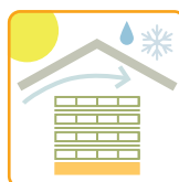
Impregnerat virke ska skyddas med topptäckning
