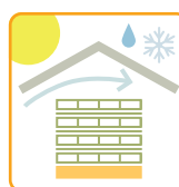
Impregnerat virke ska skyddas med topptäckning
