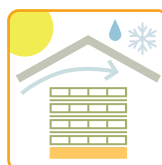
Impregnerat virke ska skyddas med topptäckning
