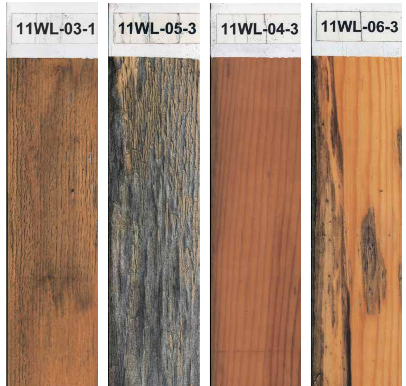
Figur 2a - träpaneler behandlade med oorganiskt uv-skydd.
